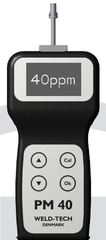
Speziell für den flexiblen Einsatz auf Baustellen und in der Werkstatt ist dieses ppm-Hand-Messgerät entwickelt worden, welches das Schweißen von Edelstahl erleichtert, indem es die Sauerstoffkonzentration bis auf 0,004% genau (40 ppm) anzeigt.
