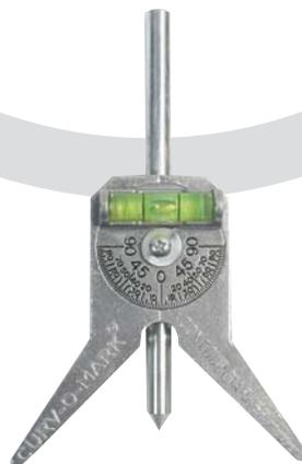
Die exakte Position (oben/ unten) eines Rohres zu finden, war schon immer ein Problem. Der WT Anreißkopf löst dieses Problem auf einfachste Weise. Man kann ihn auch dafür nutzen, um jeden vorgegebenen Punkt in einem Winkel vom Kopf des Rohres zu finden. Kann auf allen Rohren verwendet werden.
