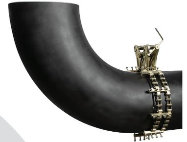
S200, D200 y DK200 son Abrazaderas de Cadena que pueden ajustar y alinear tuberías con espesores de pared de hasta 12,7 mm. Las abrazaderas de Cadena pueden siempre ser modificadas para dimensiones menores o mayores de tuberías, cambiando sólo la cantidad de empalmes de cadenas y barras.
